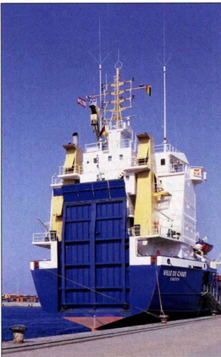
Antennen der MS Ville de Gabes /DCKB: etwa 15 m hohe Vertikalstrahler; das ist für 500 kHz nicht mehr als 1/10 einer Viertelwellenlänge und entspricht damit in Relation den Abmessungen einer 80-m-Mobilantenne im Amateurfunk. Fotos: DF2BC
