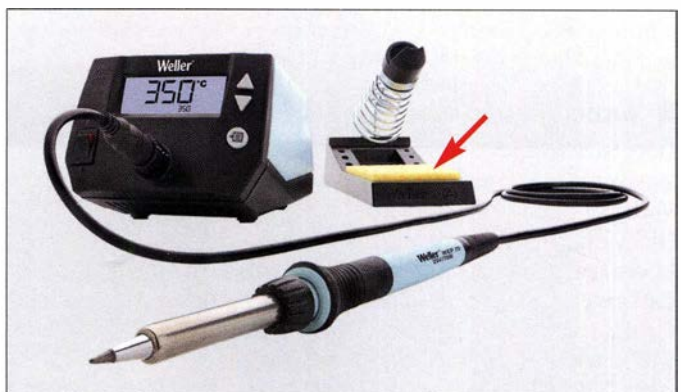
Bild 14: Lötstation Weller Digital 70 W Professional; der feuchte Reinigungsschwamm sollte keinesfalls benutzt werden. Die sonst unweigerlich auftretenden Temperaturschwankungen schaden der DauerlötKolbenspitze.
