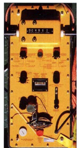
Übersichtlich angeordnete, selbst erklärende Bedienelemente und ausführlich beschriftete Frontplatte der Rettungsbootstation DEBEG 7500
