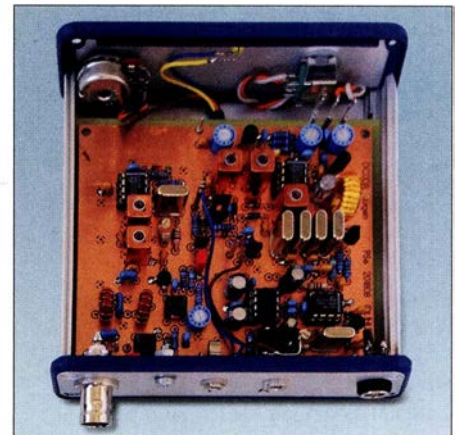
Bild 2: Die gefräste Leiterplatte lässt sich beispielsweise in das Aluminium-Design-Gehäuse des FA-Leserservices einschieben.
