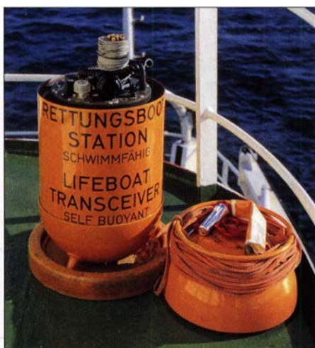
Geöffnete Rettungsbootfunkstation Telefunken SE 662; im abgeschraubten Deckel befindet sich das Zubehör.
