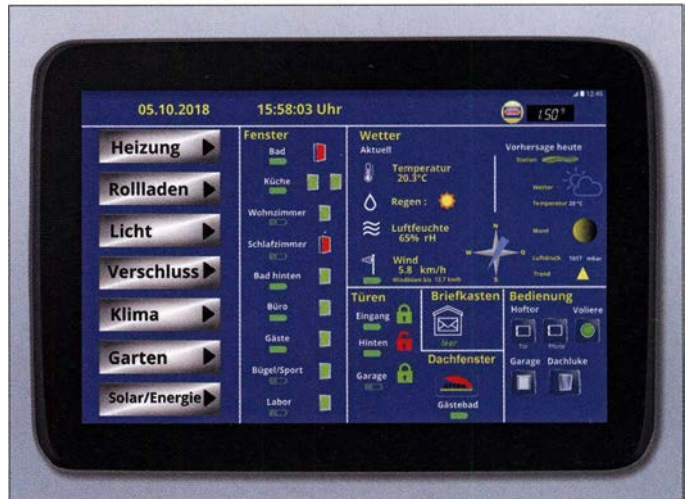
Bild 7: Mit dem AIO Creator Neo sind individuelle Kontroll- und Bedienoberfläche erstellbar, hier auf einem Tablet als zentralem Gerät. Es lassen sich über die CCU-API und Webseiten-Widgets externe Informationen einbinden, von Batteriezuständen über Wettervorhersagen bis zum Spritpreis der nächsten Tankstelle. Die großen Schaltflächen links dienen in diesem Beispiel als Platzhalter für neue Inhalte und Ideen.
