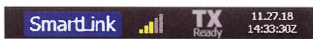
Bild 5: Die Anzeige SmartLink erscheint nur im Remote-Betrieb via Internet und ist ein Indikator der Verbindungsqualität in der SmartSDR-Bedienoberfläche, ...
