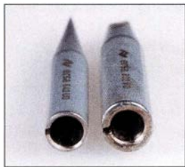
Bild 13: Schon an der Materialdicke ist die unterschiedliche Wärmeübertragung der Spitzen aus Bild 12 erkennbar.
