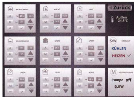
Bild 8: Beispiel der mit AIO Creator Neo erstellten Heizungssteuerung auf einem Tablet: links die Kontroll- und Steueroberflächen, rechts zentrale Statusmeldungen für die Fußbodenheizung
