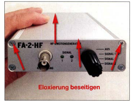
Bilder 8 und 9: „HF-„Abdichtung“ des FA-2-HF: Entfernung des Kunststoffrahmens, Generatorgehäuse an den Verbindungsstellen bearbeiten, Platinen- auf Gehäusemasse legen
