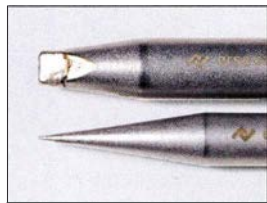
Bild 12: Vorne 5 mm breite Lötspitze 832VD und spitz zulaufende 842UD mit nur 0,4 mm Durchmesser
