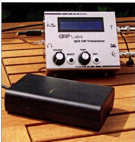
Bild 1: WSPR-Bakenbetrieb mit dem Transceiver QCX; davor liegt das GPS-Modul.
