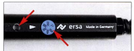
Bild 16: Die Temperatur des Ersa Multi-TC ist von 250 °C bis 450 °C einstellbar. Eine LED informiert über die Aktivierung der Heizung.
