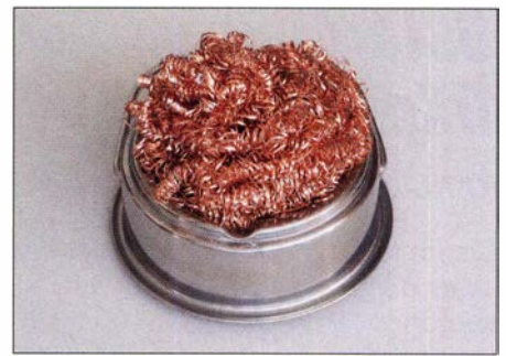
Bild 15: Kupfer- oder Messingwolle ist nicht nur gut zum Reinigen bleifreier Lötspitzen geeignet, sondern auch für bleihaltig beschichtete. Fotos: DJ3TZ
