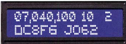
Bild 4: WSPR-Bakentextbetrieb während der Sendephase
