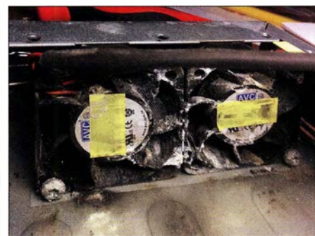
Vom Salz in der Luft lädierte Lüfter aus einem der Netzteile der 8P9AE-DXpedition Foto: DL7UFR
