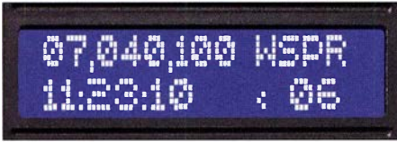
Bild 3: WSPR-Bakentextbetrieb während der Pause
