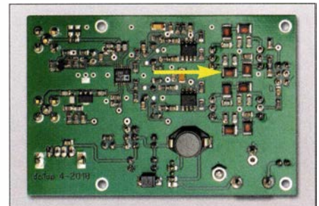
Bild 8: Lötseite der Modulatorplatine; rechts befinden sich die Filterzüge (Pfeil), links daneben die beiden Treiber-ICs.
